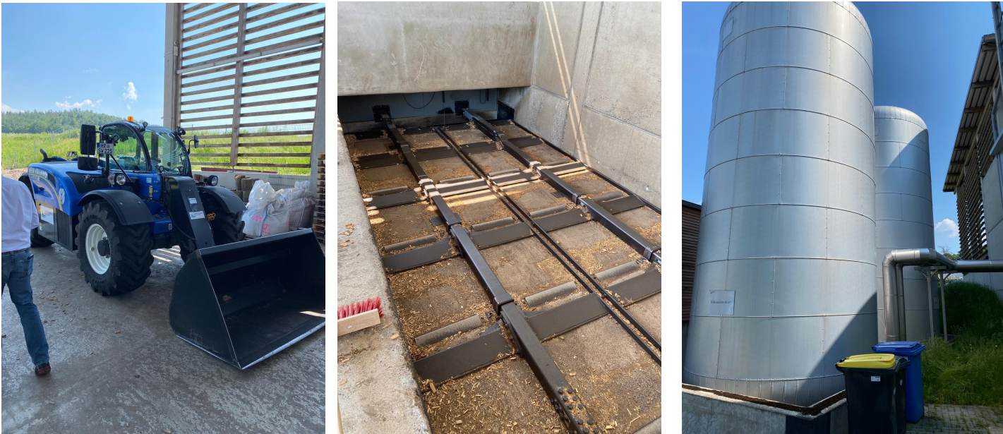
Schubboden zur Beschickung der Anlage - rechts Pufferspeicher
